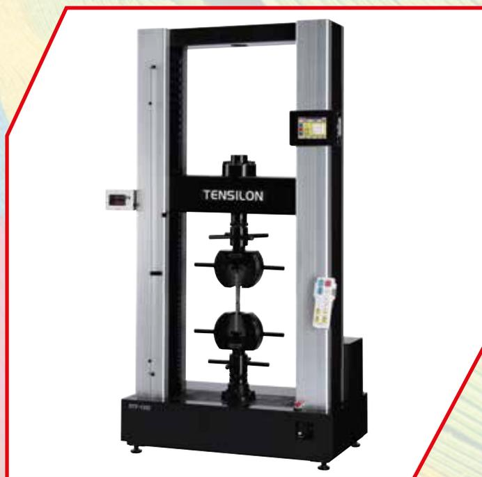
Универсальная испытательная машина – это испытательное оборудование разрушающего контроля, предназначенное определять физико-механические свойства материалов в лабораториях и на производстве. Применение машин для исследования материалов позволяет в равной степени защищать интересы как производителя, так и потребителя.
