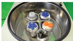
Корзины для бакет-ротора центрифуги UC-1536E
