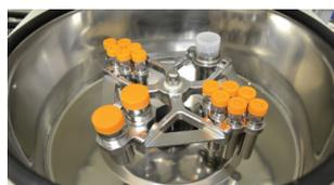
Корзины для бакет-ротора центрифуги UC-4000E
